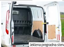
Jeklena pregradna stena z oknom
