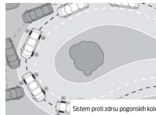
Sistem proti zdrsu pogonskih koles
