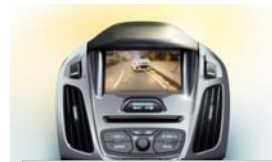
Navigacijski sistem Ford SYNC s kamero za pomoč pri vzvratni vožnji
